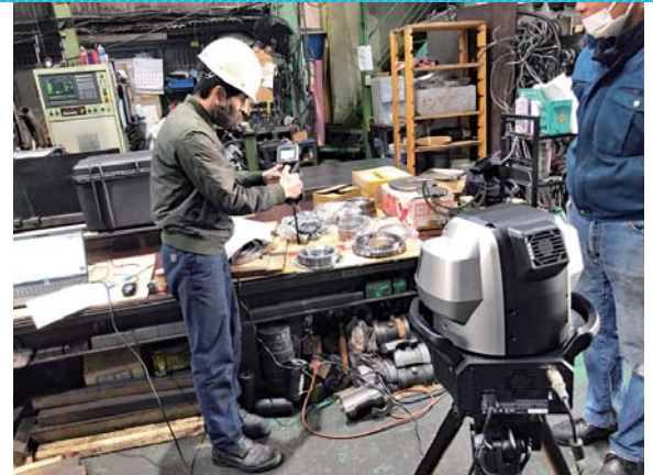
10m計測可能な最新3Dレーザー測定器
